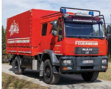
wurden Lüftungsöffnungen verschlossen und der Tankstutzen umgeschweißt. Um das Fahrzeug kompakter zu gestalten, haben unsere Fahrzeugspezialisten die Laдебordwand um einen halben Meter versetzt.
